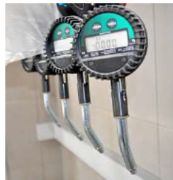
Mit diesen Armaturen lässt sich Motorenöl einfüllen.
